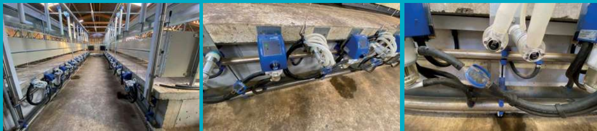
LES PORTES À POSITIONNEMENT OBLIQUE DE LA SALLE DE TRAITE SIDE BY SIDE PERMETTENT AUX CHÈVRES D'ENTRER ET DE SORTIR FACILEMENT.
